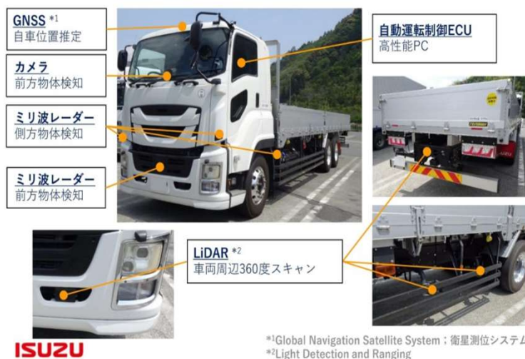
高性能センサーと制御システムを搭載した、いすゞの大型トラックの自動運転車両
