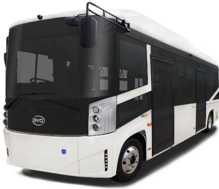
小型電気バス「J6」/車長 6.99m/航続距離約 200km
