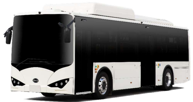
大型電気バス「K8」/車長 10.5m/航続距離約 220km
