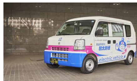
【バッテリー交換式コンバージョンEV】
