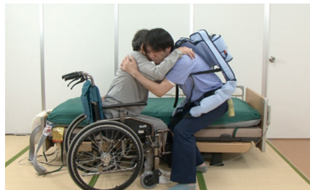
「マッスルスーツ」は空気圧式の人工筋肉により稼働し、装着者が人や物を持ち上げる際の体の負担を大幅に軽減します。
